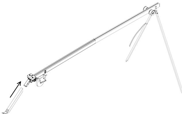
Рис. 3: Присоединение задней части
