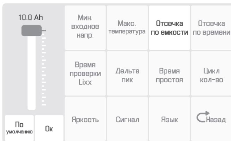
Рис. 10: Отсечка по емкости
